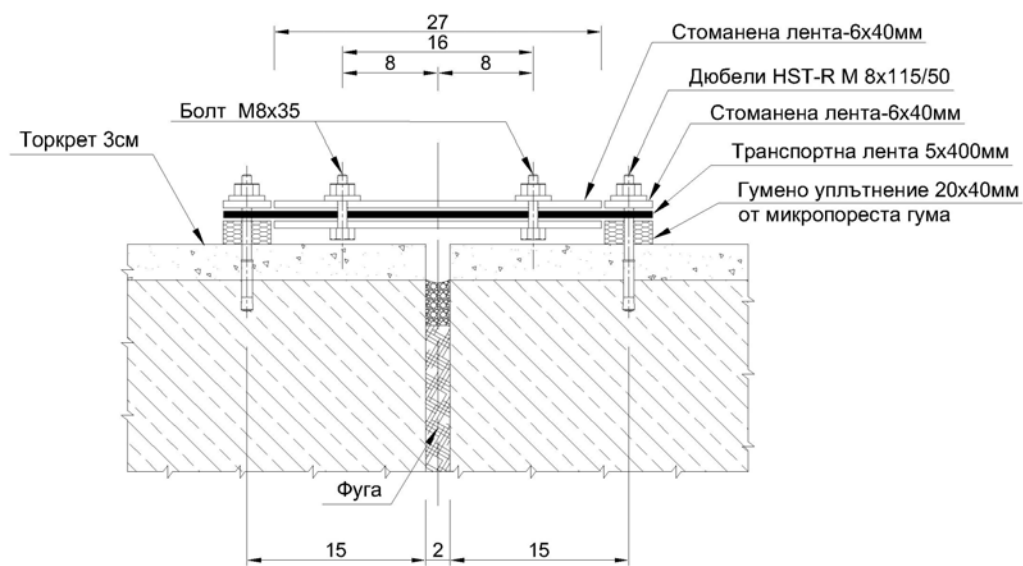
Фигура 4.2.4 - Ремонт на фуги по детайл “Енергопроект” - разреза и детайли
